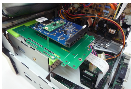
Classic II に BlueSCSI v2 を 3 点止めの例 (内蔵 SCSI ケーブルはまだ接続されていません)
