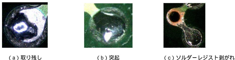
図 3-16 クリーニング作業での不具合例
