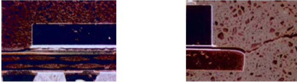
図4-12 パッケージクラック写真
