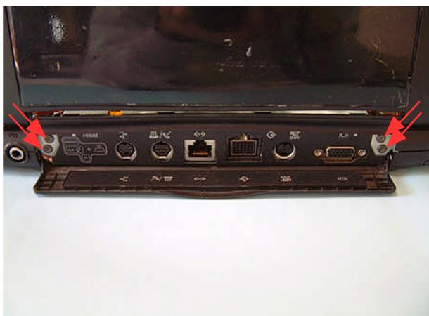
本体背面の液晶パネルを固定している4本のネジを外します
