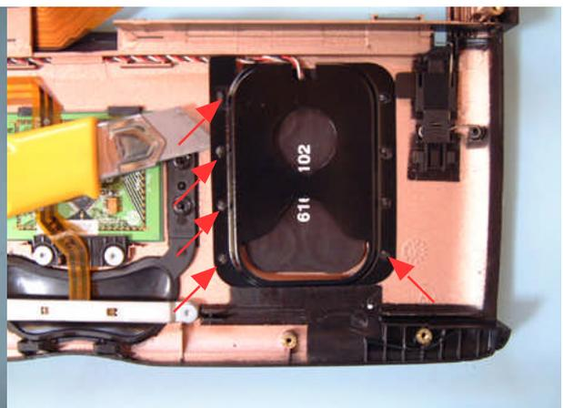
矢印の5ヶ所にカッターナイフを差込み、熱接合部分を、周囲を傷つけないよう慎重に分断します
