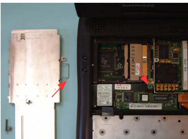
金属カバーを取っ手を持って外し、モデムユニットの固定ネジをはずす
