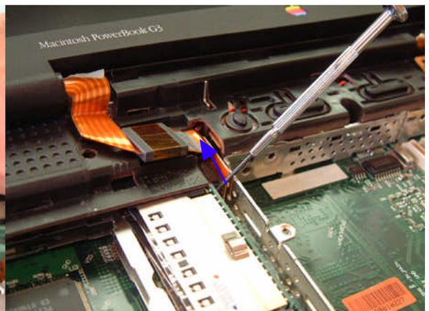
液晶パネルのコネクタ（左）のプラスチック部分を、マイナスドライバで前後させコネクタをゆるめて引き抜く
