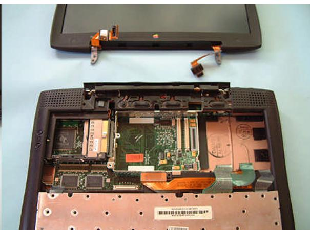
液晶パネルを垂直に引き上げて本体から抜き出します
