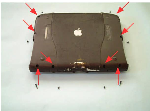
本体底面の8本のネジ（長2本、短6本）を外します。
