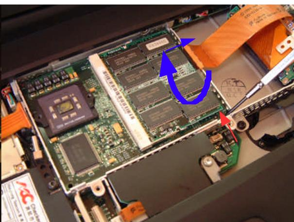
ドータ（CPU）ボードの右下すみのすき間にドライバーを差込んでテコの原理で持ち上げ、コネクタが上下に外れたら、右方向に抜く
